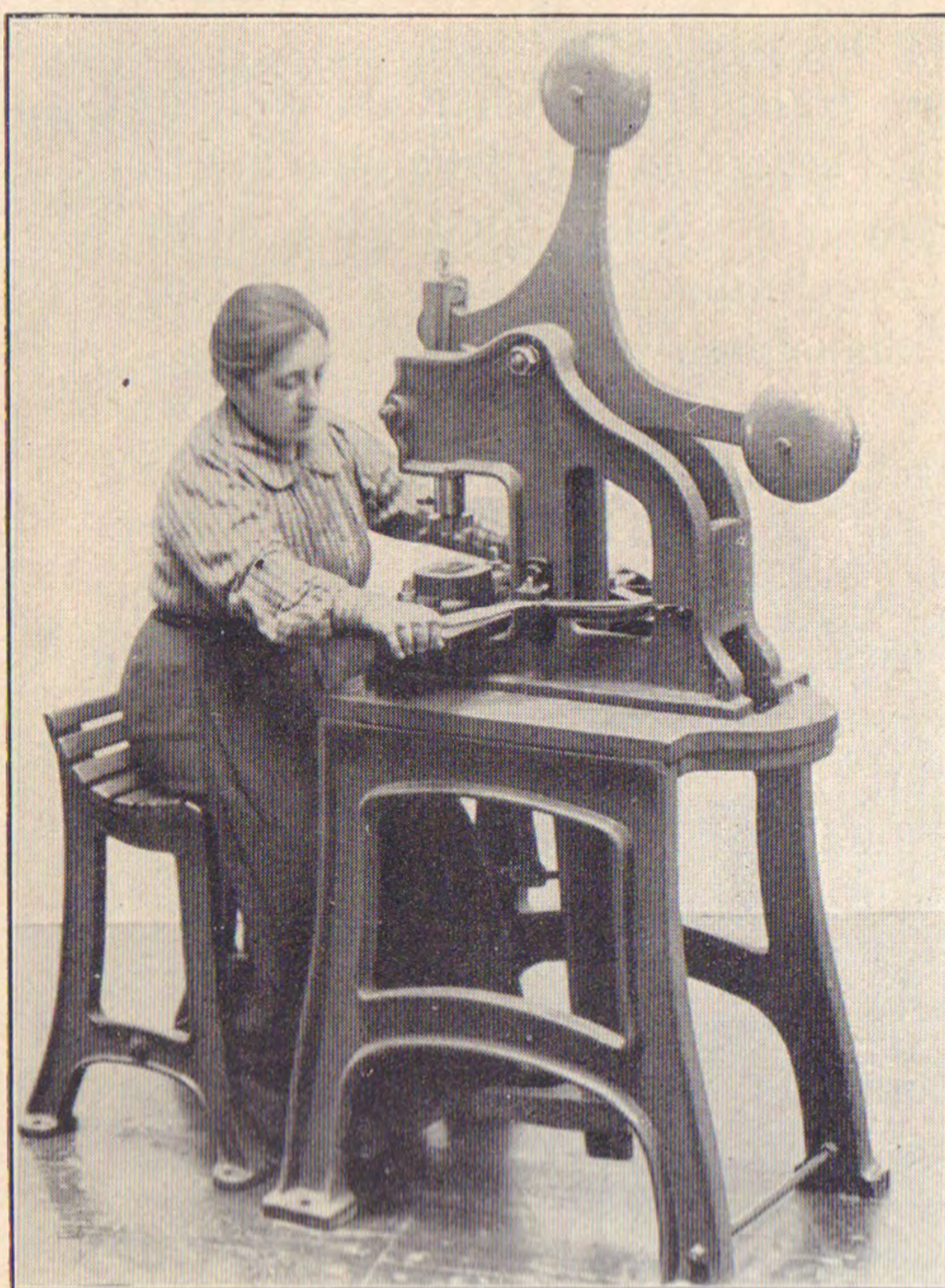
Pendelschlagpresse für Seifenfabrikation mit Unfallverhütungsvorrichtung System Hertel.
